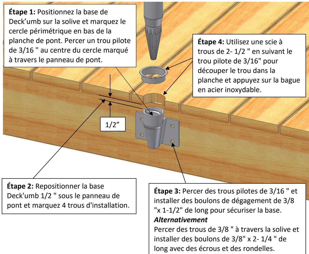
**Étape 5:** Insérez le support Deck'umb et alignez la goupille avec les ouvertures des fentes. Tournez le support dans le sens des aiguilles d'une montre jusqu'à ce qu'il s'arrête, puis tournez dans le sens inverse des aiguilles d'une montre pour le verrouiller dans la base.
